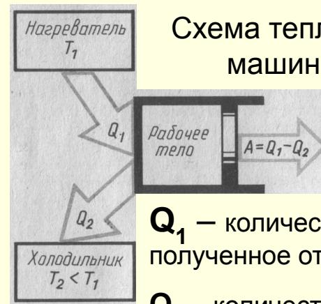
Схема тепловой машины
