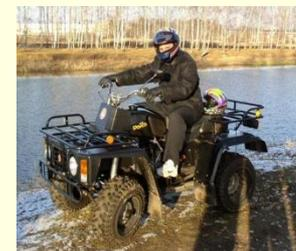
Квадроцикл "РЫСЬ" 2-х цилиндровый, 2-х тактный карбюраторный двигатель с водяным охлаждением.
