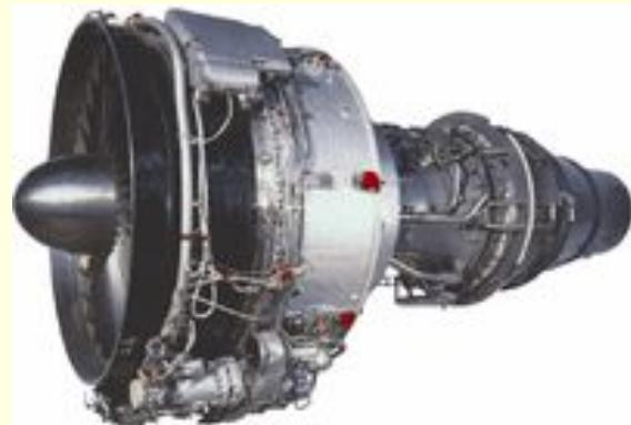
Авиационный турбореактивный двигатель Д-36 предназначен для установки на самолеты Як-42, Ан-72, Ан-74 и экранопланы "Комета-2" и "Вихрь-2". Двигатель прошел стендовые испытания в 1971 г. С 1981 г. эксплуатируется в ГА
