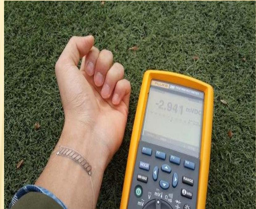
Термоэлектрическое устройство, которое позволяет преобразовывать тепло тела в электрическую энергию
