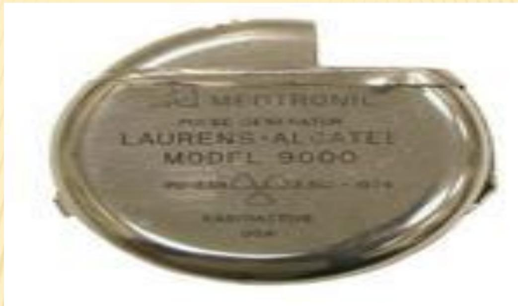
*Кардиостимулятор, работающий от термоэлектрической батареи на плутонии-238, способный работать более 20 лет*
