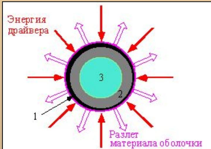
Мишень для УТС состоит из поллой оболочки (1), слоя твердой замороженной ДТ смеси (2) и ДТ газа низкой плотности в центре мишени (3).
