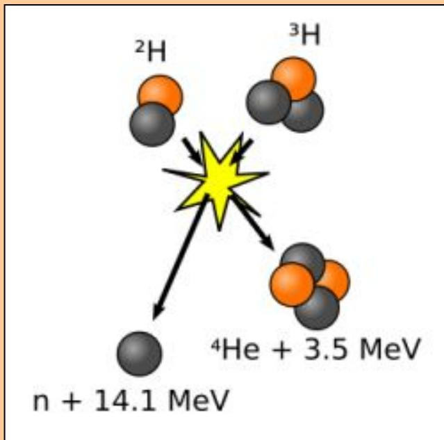
Для того, чтобы произошла реакция синтеза, исходные ядра должны попасть в сферу действия ядерных сил (сблизиться на расстоянии  $10^{-14}$  м), преодолев силу электростатического отталкивания. Это возможно при большой кинетической энергии ядер. Для этого вещество должно иметь температуру  $10^7$  К. Поэтому реакция названа «термоядерной» (от лат. *therme-тепло*).
