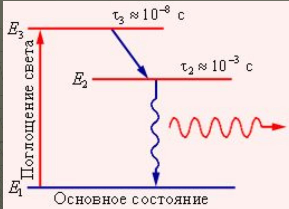
Трехуровневая схема оптической накачки. Указаны «времена жизни» уровней  $E_2$  и  $E_3$ . Уровень  $E_2$  – метастабильный. Переход между уровнями  $E_3$  и  $E_2$  безызлучательный. Лазерный переход осуществляется между уровнями  $E_2$  и  $E_1$ . В кристалле рубина уровни  $E_1$ ,  $E_2$  и  $E_3$  принадлежат примесным атомам хрома
