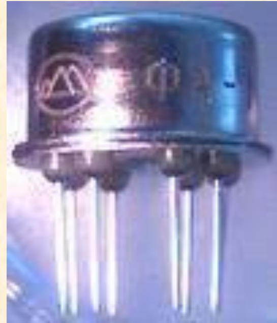
Фоторезистор (используется зависимость сопротивления от освещения)
