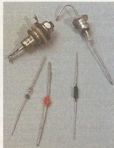
Простейший полупроводниковый прибор — диод.
