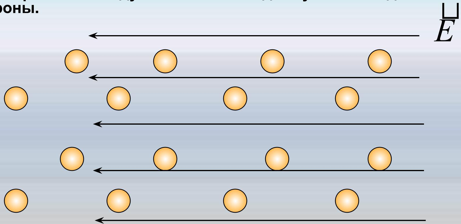
Электрическое поле сообщает им ускорение в направлении, противоположном направлению вектора напряженности поля. Поэтому в электрическом поле беспорядочно движущиеся электроны смещаются в одном направлении, т.е. движутся упорядоченно.
