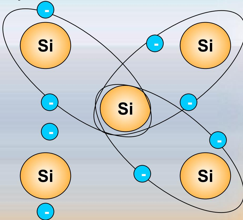
Кремний – 4 валентный химический элемент. Каждый атом имеет во внешнем электронном слое по 4 электрона, которые используются для образования парноэлектронных (ковалентных) связей с 4 соседними атомами
