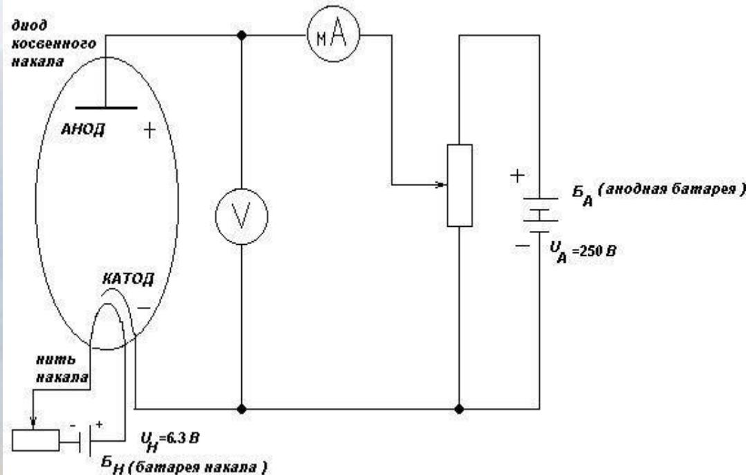
Вакуумный диод обладает односторонней проводимостью. При изменении полярности включения  $B_A$ , ток в анодной цепи не регистрируется.
