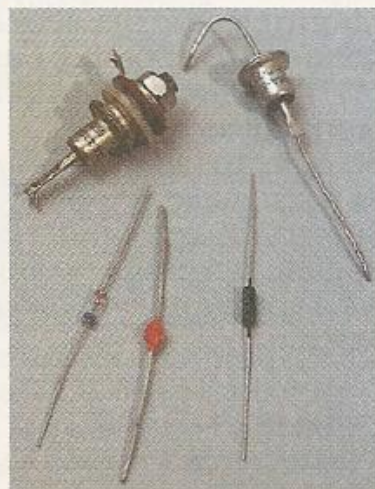
Простейший полупроводниковый прибор — диод.
