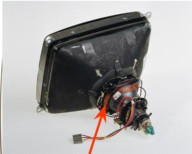
Кинескоп – электронно – вакуумная трубка, предназначенная для создания телевизионного изображения
