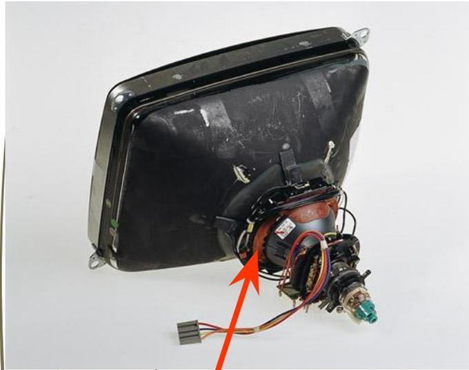
**Кинескоп** – электронно – вакуумная трубка, предназначенная для создания телевизионного изображения
