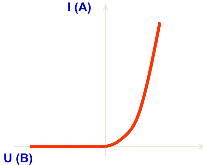
Вакуумный диод обладает **односторонней проводимостью** и применяется для выпрямления переменного тока (кенотрон)
