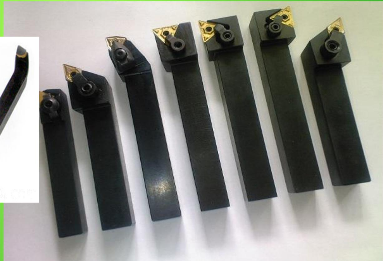
Резцы с механическим креплением пластин имеют значительные преимущества перед напайными резцами, так как при такой конструкции резца предотвращается возможность появления трещины в пластинах при напайке, удлиняется срок службы крепежной части резца.
