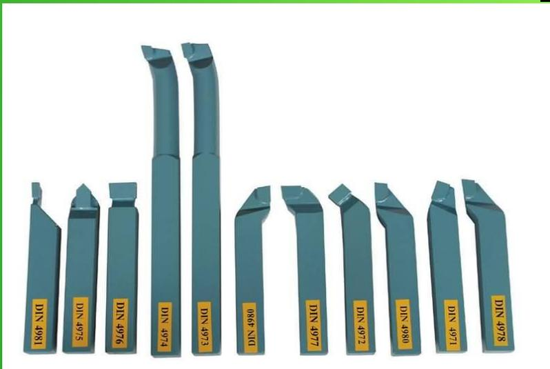
Проходные прямые и отогнутые резцы — могут устанавливаться на станках как с поперечной, так и с продольной подачей. Применяются для обработки наружных поверхностей (подрезки торцов, обточки, формирования деталей конической и цилиндрической формы).
