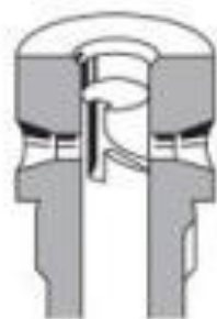
Максимальная подача топлива Начало подачи топлива (отверстие закрывается)
