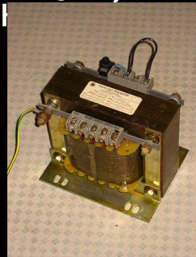
Понижающий трансформатор – трансформатор, уменьшающий напряжение ( $U_2 < U_1$ ). У понижающего трансформатора число витков во вторичной обмотке должно быть меньше числа витков в первичной обмотке, т.е.  $k > 1$ .
