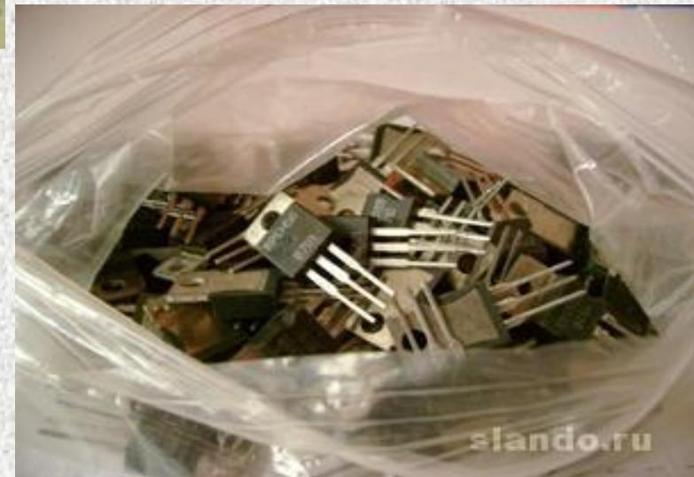
Полевой транзистор — полупроводниковый прибор, в котором ток изменяется в результате действия перпендикулярного току электрического поля, создаваемого входным сигналом.
