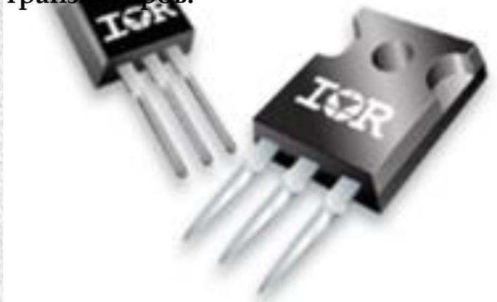
Биполярный транзистор — трёхэлектродный полупроводниковый прибор, разновидность транзистора. Электроды подключены к трём последовательно расположенным слоям полупроводника с чередующимся типом примесной проводимости. По этому способу чередования различают  $npr$  и  $pnp$  транзисторы ( $n$ - negative) — электронный тип примесной проводимости, ( $p$ - positive — дырочный).
