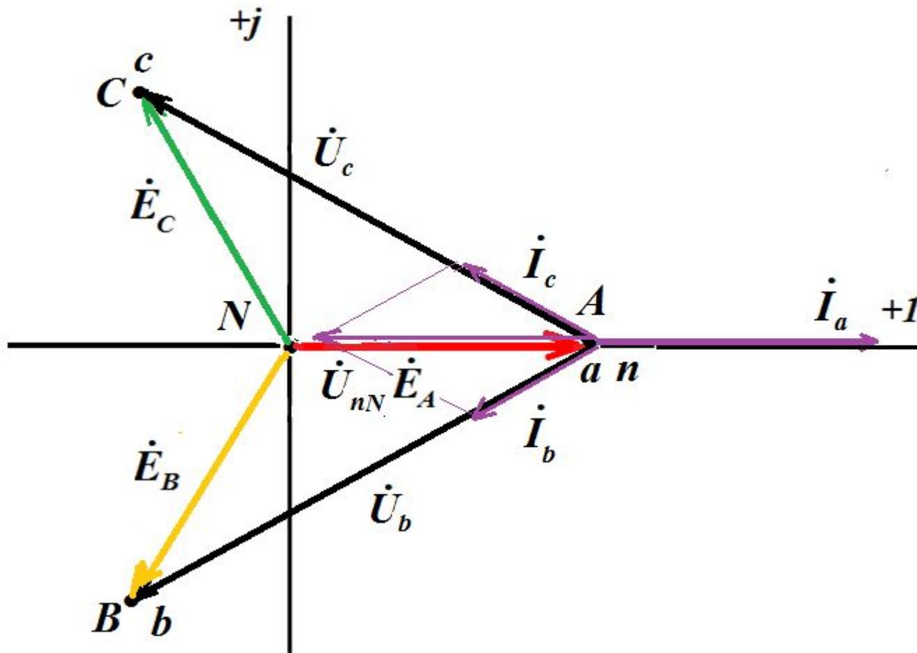
При коротком замыкании в симметричном приемнике токи в неповрежденных фазах возрастают в  $\sqrt{3}$ .
