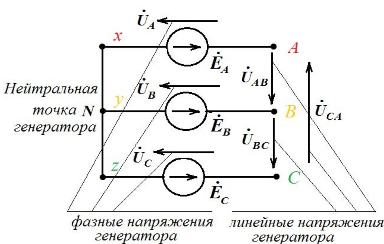
$$\begin{aligned} \dot{U}_A &= \dot{E}_A \\ \dot{U}_B &= \dot{E}_B \\ \dot{U}_C &= \dot{E}_C \\ \dot{U}_{AB} &= \dot{E}_A - \dot{E}_B \\ \dot{U}_{BC} &= \dot{E}_B - \dot{E}_C \\ \dot{U}_{CA} &= \dot{E}_C - \dot{E}_A \end{aligned}$$
