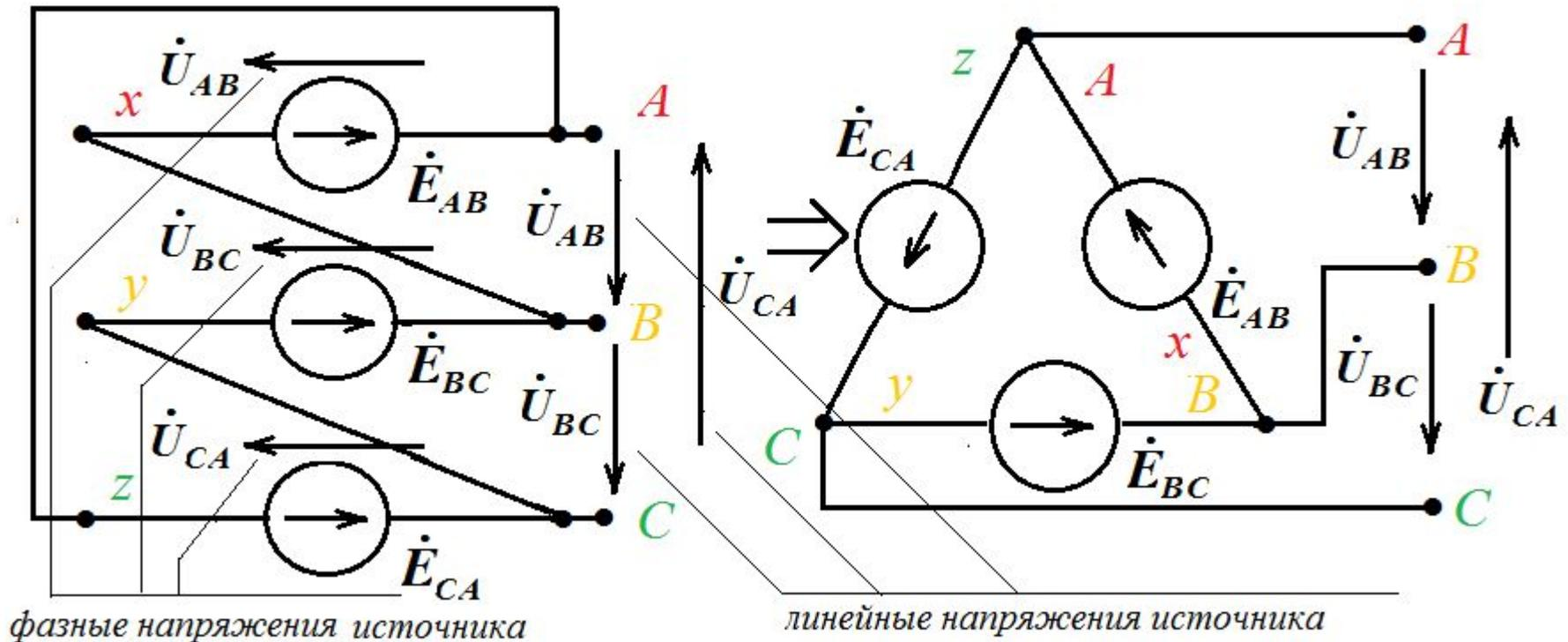
При соединении фаз генератора в «треугольник»
