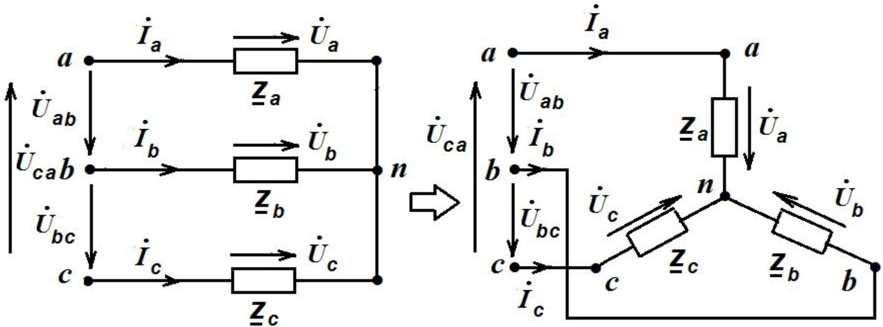
При соединении трехфазного приемника «звезда» фазные и линейные токи совпадают
