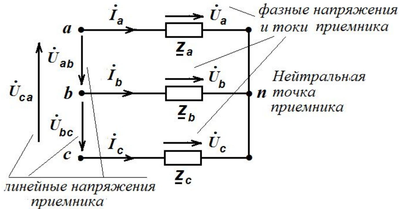
Возможные изображения схемного соединения приемника
