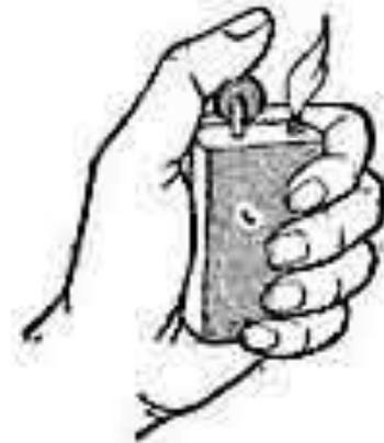
**В современной зажигалке** воспламенение горючего производится под действием искры, получающейся от сгорания мельчайшей частицы «кремня», срезанной зубчатым колесиком - кресалом.
