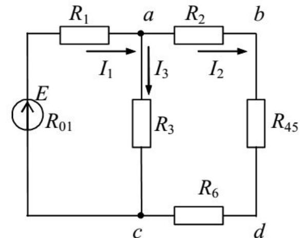
Сопротивления  $R_2$ ,  $R_4$  и  $R_6$  соединены последовательно друг с другом, их эквивалентное сопротивление:
