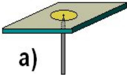
а) При соприкосновении раскаленной иглы к тонкой пластинке на противоположной стороне плавится парафин.
