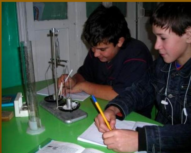
Пользуясь методом Архимеда, мы определили объем цилиндра, опустив его в мензурку с водой.
