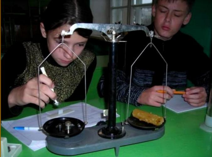
Чтобы найти плотность парафиновой свечи, мы сначала нашли ее массу (взвесили на весах), а затем объем, опустив свечу в мензурку с водой.
