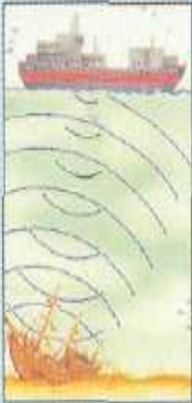
Ультразвуковые волны, посланные с корабля, отражаются от затонувшего предмета. Компьютер засекает время появления эха и определяет местоположение предмета.
