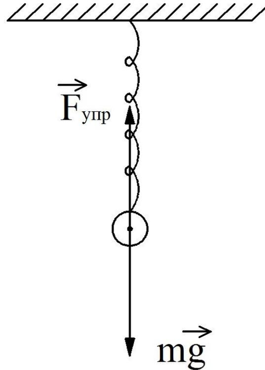
Колебательная система - опора, тело, пружина, Земля.
