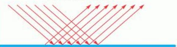
При зеркальном отражении угол падения равен углу отражения
