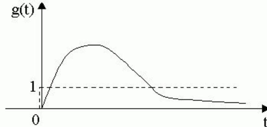
Чем шире частотная характеристика, тем короче переходные процессы в усилителе; так нижняя граничная частота УНЧ отвечает за неискаженную передачу медленно меняющейся части усиливаемого сигнала (например, полочки в импульсе прямоугольной формы), а верхняя граничная частота – за неискаженную передачу быстроменяющейся части сигнала (например, фронтов прямоугольных импульсов).
