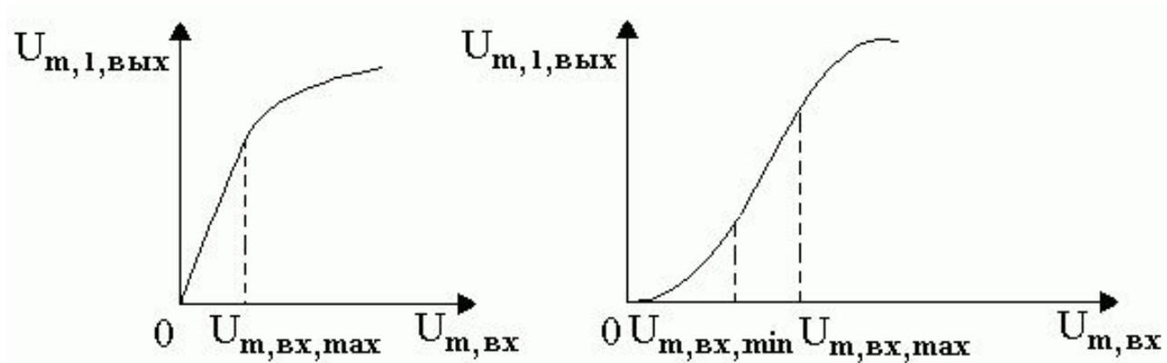
Амплитуды входного сигнала  $U_{m, вх, min}$  и  $U_{m, вх, max}$  определяют динамический диапазон усилителя.
