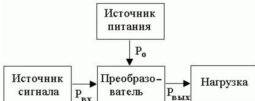
Сравнительно маломощный входной сигнал управляет большой энергией источника питания, благодаря чему на нагрузке выделяется усиленный сигнал.
