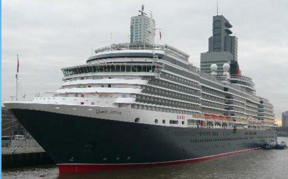
Из стали делают лишь тонкий корпус судна, а большая часть его объема занята воздухом. Среднее значение плотности судна оказывается значительно меньше плотности воды. Поэтому оно не только не тонет, но и может принимать для перевозки большое количество грузов.
