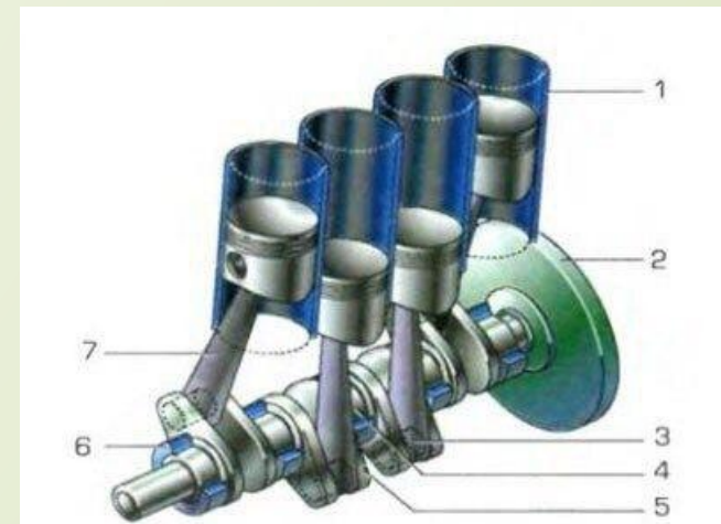
Схема кривошипно-шатунного механизма: 1 – цилиндр; 2 – маховик; 3 – шатунный подшипник; 4 – коленчатый вал; 5 – колено; 6 – коренной подшипник; 7 – шатун.
