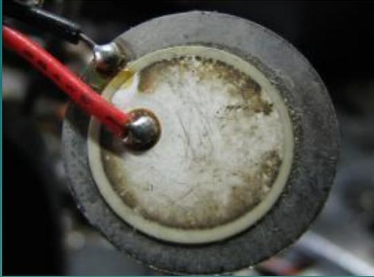
*Пьезоэлектричество* — способность вещества при изменении формы продуцировать электрическую силу. Пьезоэлектрики — кристаллы, обладающие свойством при сжатии продуцировать электрический заряд (прямой пьезоэффект) и обратным свойством под действием электрического напряжения изменять форму: сжиматься/расширяться, скручиваться, сгибаться (обратный пьезоэффект).
