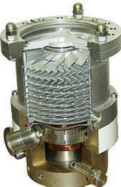
**Турбомолекулярный насос** - один из видов вакуумных насосов, служащий для создания и поддержки высокого вакуума. Действие турбомолекулярного насоса основано на сообщении молекулам откачиваемого газа дополнительной скорости в направлении откачки вращающимся ротором. Ротор состоит из системы дисков. Скорость вращения ротора - десятки тысяч оборотов в минуту. Для работы требует применения форвакуумного насоса.
