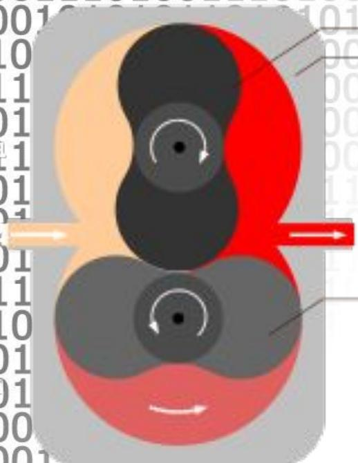
Объёмные насосы осуществляют откачуку за счёт периодического изменения объёма рабочей камеры. В основном они используются для получения предварительного разрежения. К ним относятся поршневые, жидкостно-кольцевые, ротационные (вращательные). Наибольшее распространение в вакуумной технике получили вращательные насосы.
