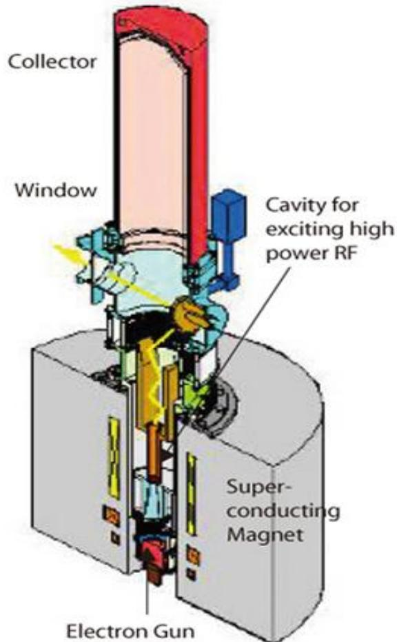
Гиротрон — электровакуумный СВЧ прибор, с электронным пучком, вращающимся с циклотронной частотой в сильном магнитном поле. Представляет собой разновидность мазера на свободных электронах.
