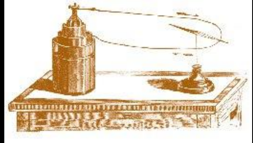
Відхилення магнітної стрілки під дією струму
