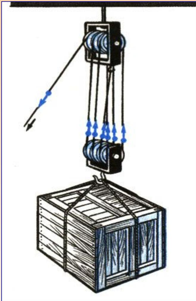
Полиспаст представляет собой комбинацию из двух обойм, одна из которых состоит из трех неподвижных блоков, а другая из трех подвижных блоков.
