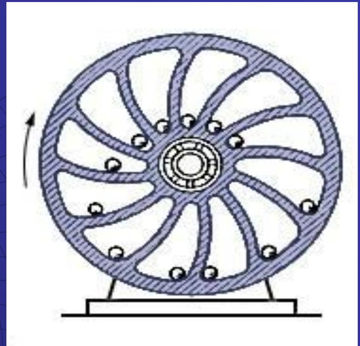
Схема одного из проектов вечного двигателя, основанного на действии силы тяжести.
