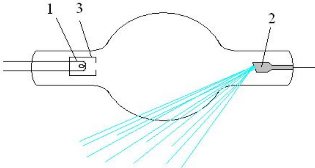
1. Вольфрамовая спираль (Катод) – Испускает электроны за счёт термоэлектронной эмиссии
