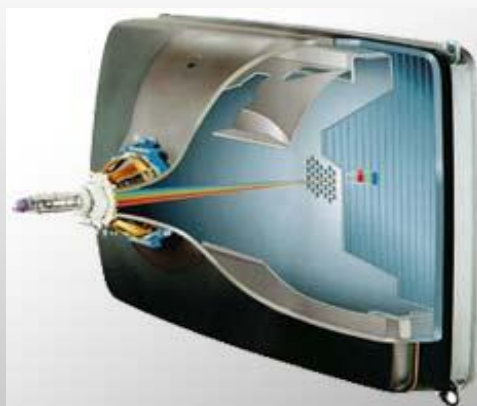
Электронно–лучевая трубка телевизоров
