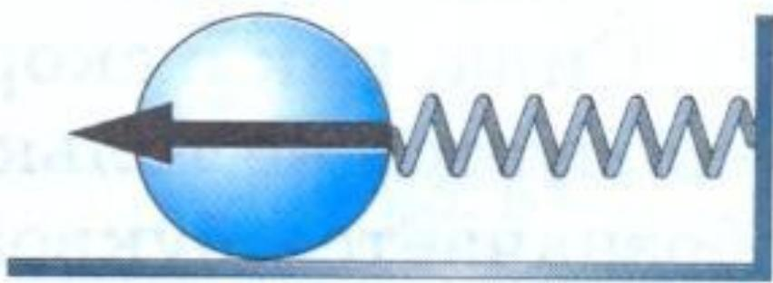
Действуя на пружину рукой, можно её сжать. Сначала в движение приходит конец пружины. Затем движение передаётся остальным её частям. Сжатая пружина, распрямляясь, может, например, привести в движение шарик.
