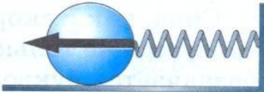
Действуя на пружину рукой, можно её сжать. Сначала в движение приходит конец пружины. Затем движение передаётся остальным её частям. Сжатая пружина, распрямляясь, может, например, привести в движение шарик.
