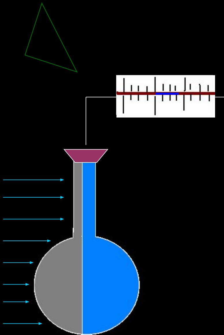
К тёмной поверхности термоскопа поднесём кусок металла, нагретого до высокой температуры. Столбик жидкости на шкале переместиться вправо.
