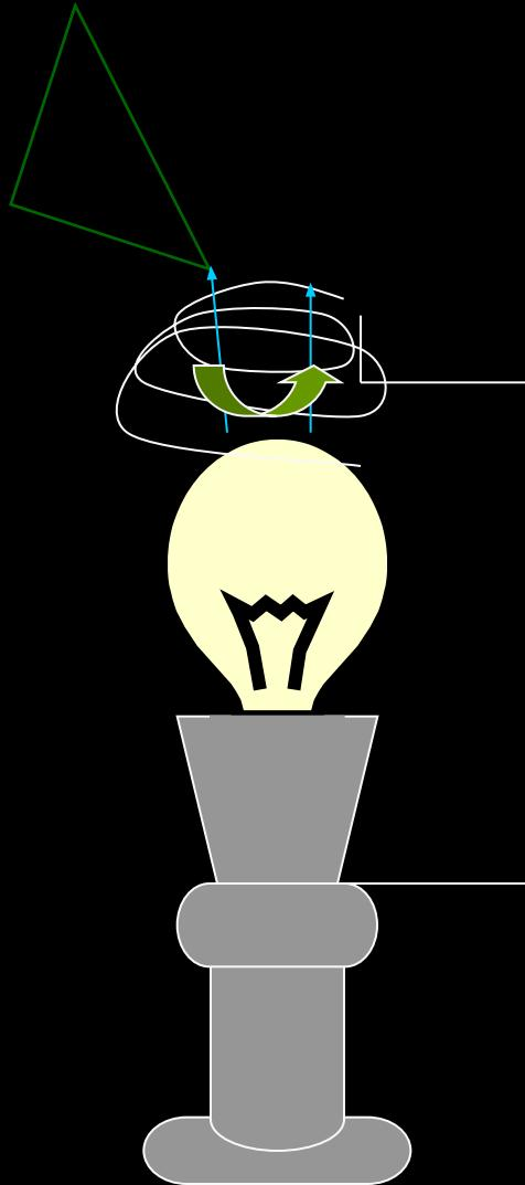
Бумажная вертушка, поставленная над пламенем свечи или электрической лампочкой, под действием поднимающегося нагретого воздуха начинает вращаться.
