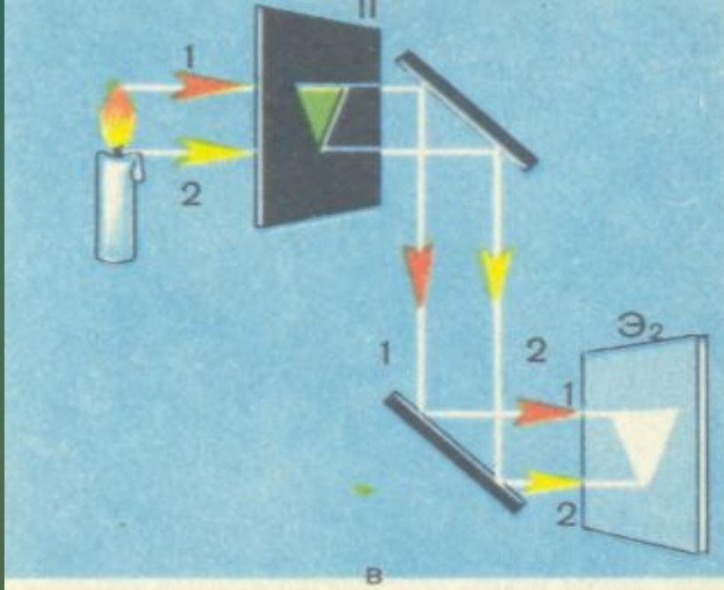
Перископ, изобретенный Ломоносовым состоял: из вертикальной трубы, механизма для наводки верхнего зеркала на объект и механизма вращения трубы вокруг вертикальной оси. Пользуясь им, можно было обозревать из-за укрытия любые объекты.
