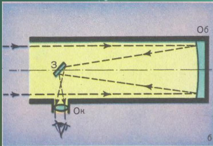
Ломоносов принял простое и весьма остроумное решение: отклонить большое зеркало телескопа «от обычного положения на четыре градуса».
