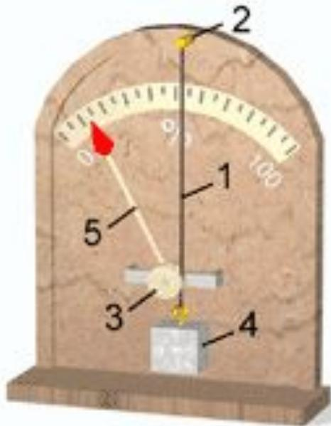
**Волосяной гигрометр**, в котором деталь, чувствительной к изменению влажности, служит обезжиренный человеческий волос [1]. Он закреплен в верхней части прибора [2], обернут вокруг ролика [3] и натянут при помощи специально подобранного груза [4]. К ролику прикреплена стрелка [5]. При увеличении относительной влажности воздуха волос удлиняется и вызывает вращение ролика вместе со стрелкой. Стрелка, передвигаясь по шкале, указывает значение влажности воздуха, выраженное в процентах.
