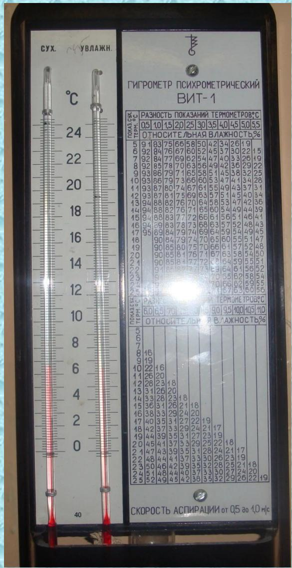
**Психрометр.** Относительную влажность можно найти с помощью специального прибора – психрометра. Психрометр состоит из двух термометров, шарик одного из них сухого и влажного термометров (так называемая психрометрическая разность) зависит от относительной влажности воздуха. Зная эту разность температур, определяют относительную влажность воздуха по специальным психрометрическим таблицам
