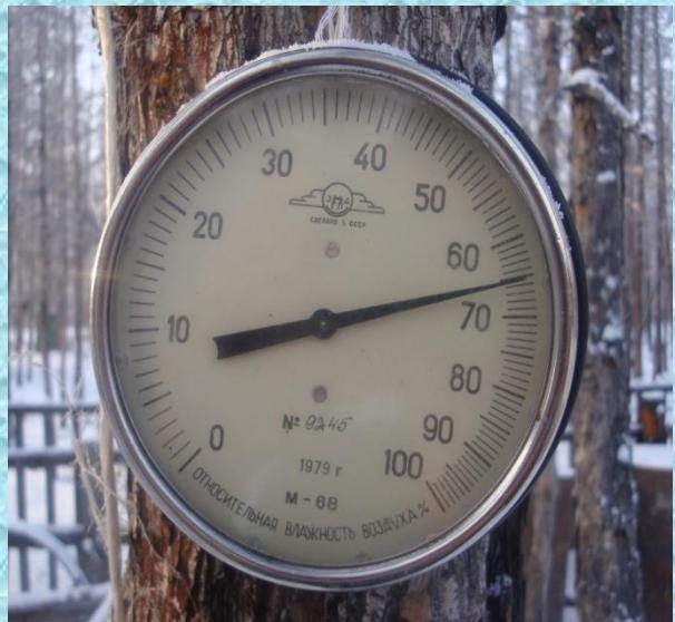
**Волосной гигрометр** в круглой оправе имеет металлический корпус, где помещается механизм гигрометра, смонтированный с обратной стороны шкалы. Между шкалой и защитным стеклом устанавливается рант, а сверху плотно надевается зажимное кольцо.
