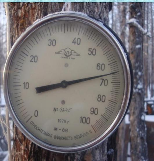
**Волосной гигрометр** в круглой оправе имеет металлический корпус, где помещается механизм гигрометра, смонтированный с обратной стороны шкалы. Между шкалой и защитным стеклом устанавливается рант, а сверху плотно надевается зажимное кольцо.
