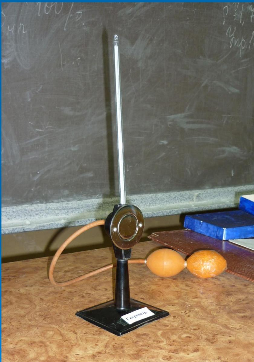
С помощью гигрометра измеряют *точку росы* – температуру, до которой необходимо охладить воздух, чтобы содержащийся в нем водяной пар, остывая, стал насыщенным.
