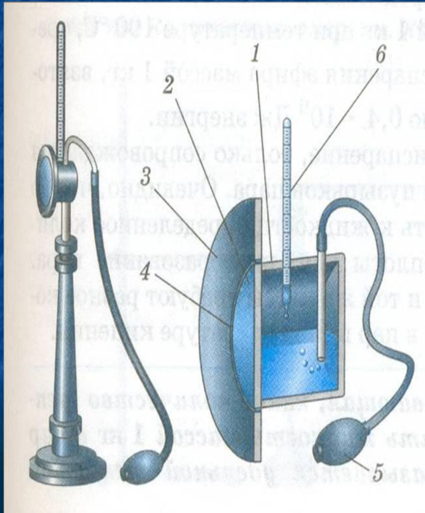
Принцип действия основан на сильном испарении эфира и быстрым охлаждении металлической коробки. По термометру снимают точку росы, а затем определяют относительную влажность воздуха. Определение точки росы - наиболее точный способ измерения относительной влажности воздуха.
