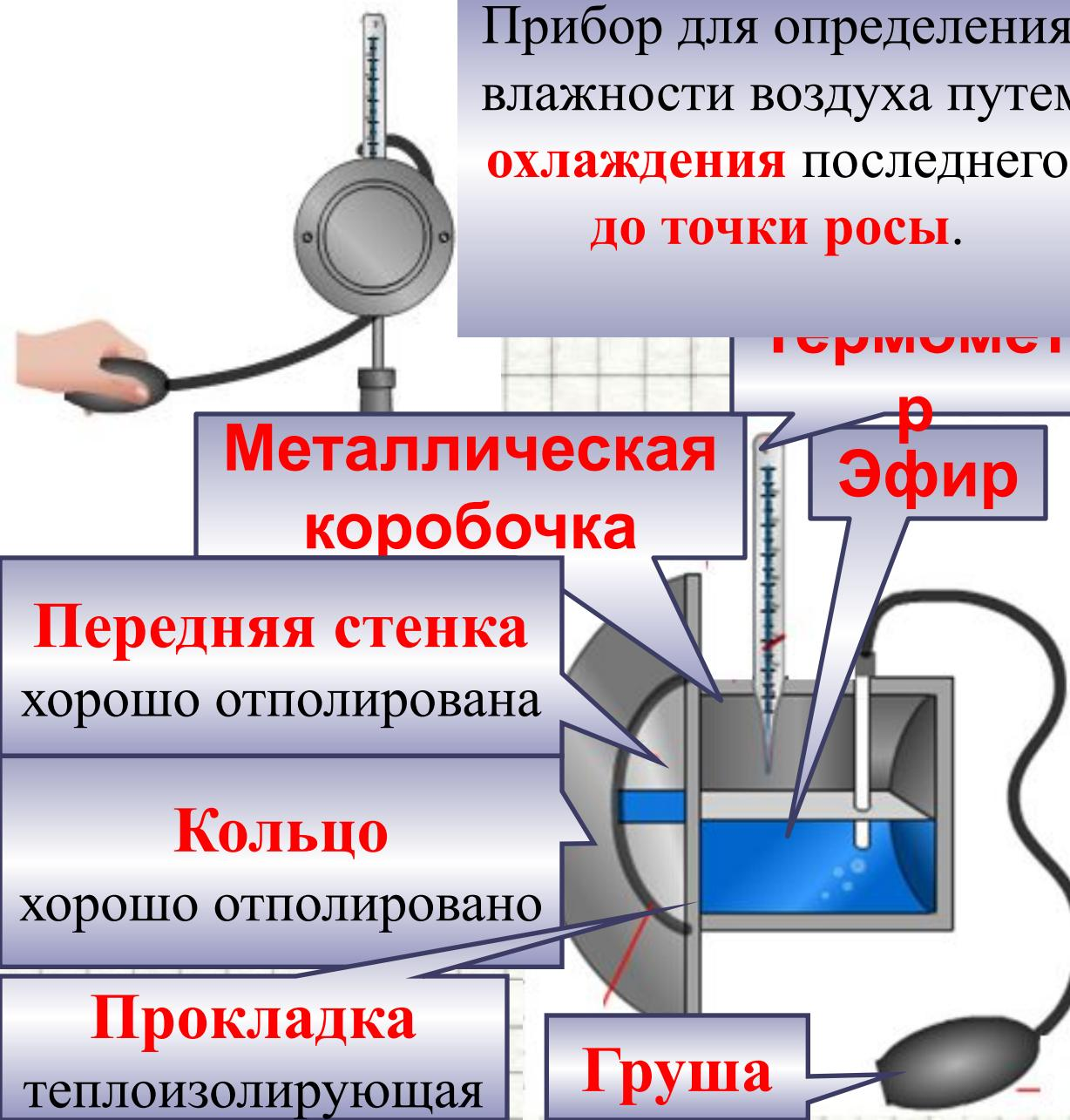
Прибор для определения влажности воздуха путем **охлаждения** последнего до **точки росы**.
