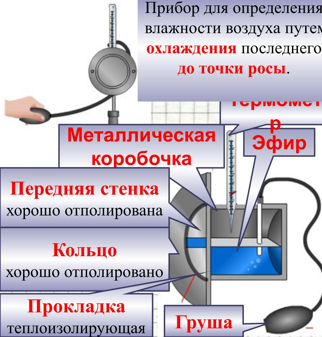
Прибор для определения влажности воздуха путем **охаждения** последнего до **точки росы**.
