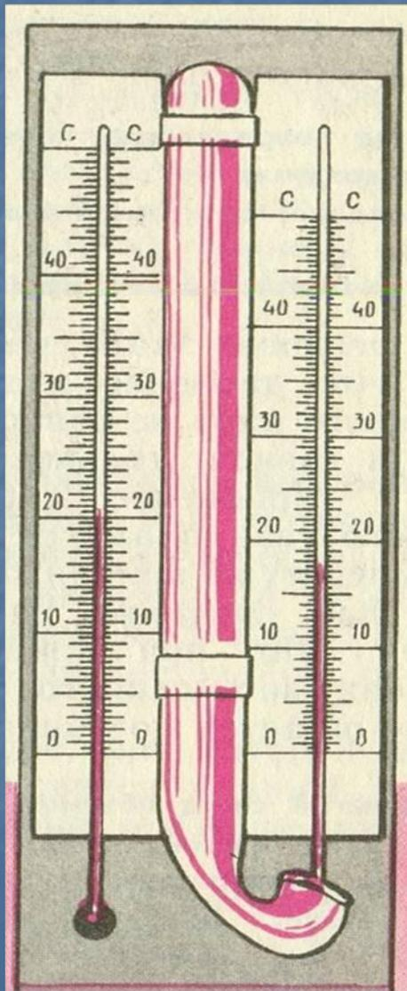
*По разности температур двух термометров: сухого и влажного и с помощью психрометрических таблиц определяют относительную влажность воздуха. Психрометром обычно пользуются в тех случаях, когда требуется достаточно точное и быстрое определение влажности воздуха.*
