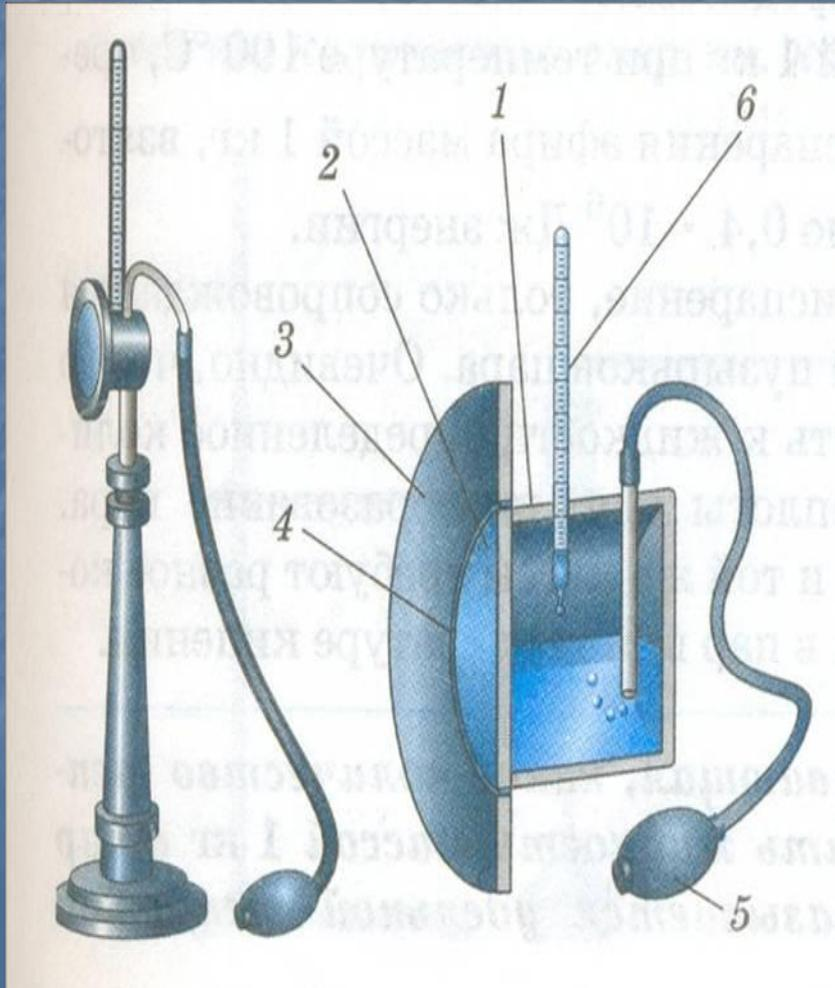
Принцип действия основан на сильном испарении эфира и быстром охлаждении металлической коробки. По термометру снимают точку росы, а затем определяют относительную влажность воздуха. Определение точки росы - наиболее точный способ измерения относительной влажности воздуха.
