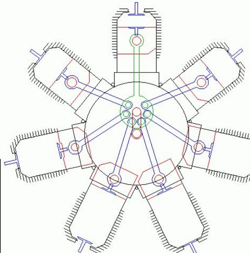
Один из самых популярных роторных двигателей военных самолетов времен Первой Мировой войны. Коленчатый вал этого двигателя крепился к корпусу самолета, в то время как цилиндры вращались вместе с пропеллером.
