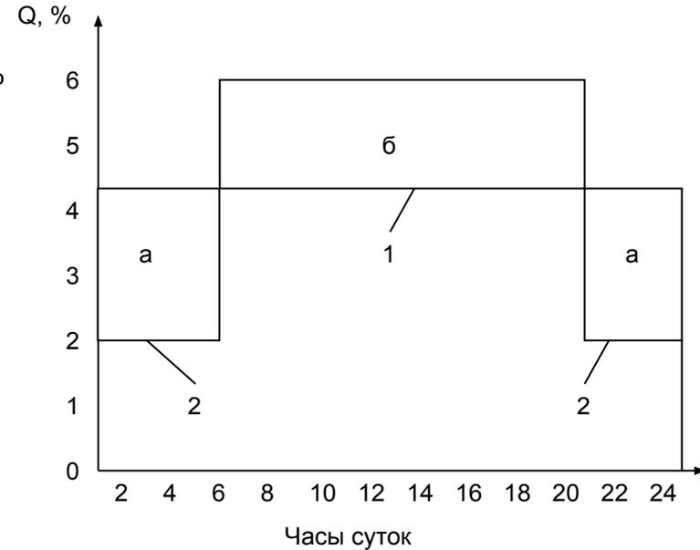
Регулирующий объем РЧВ определяется наибольшей из отдельных площадей **а** или **б**, образуемых **линией 1** режима работы НС 1-го подъема и ступенчатой **линией 2** режима работы НС 2-го подъема.
