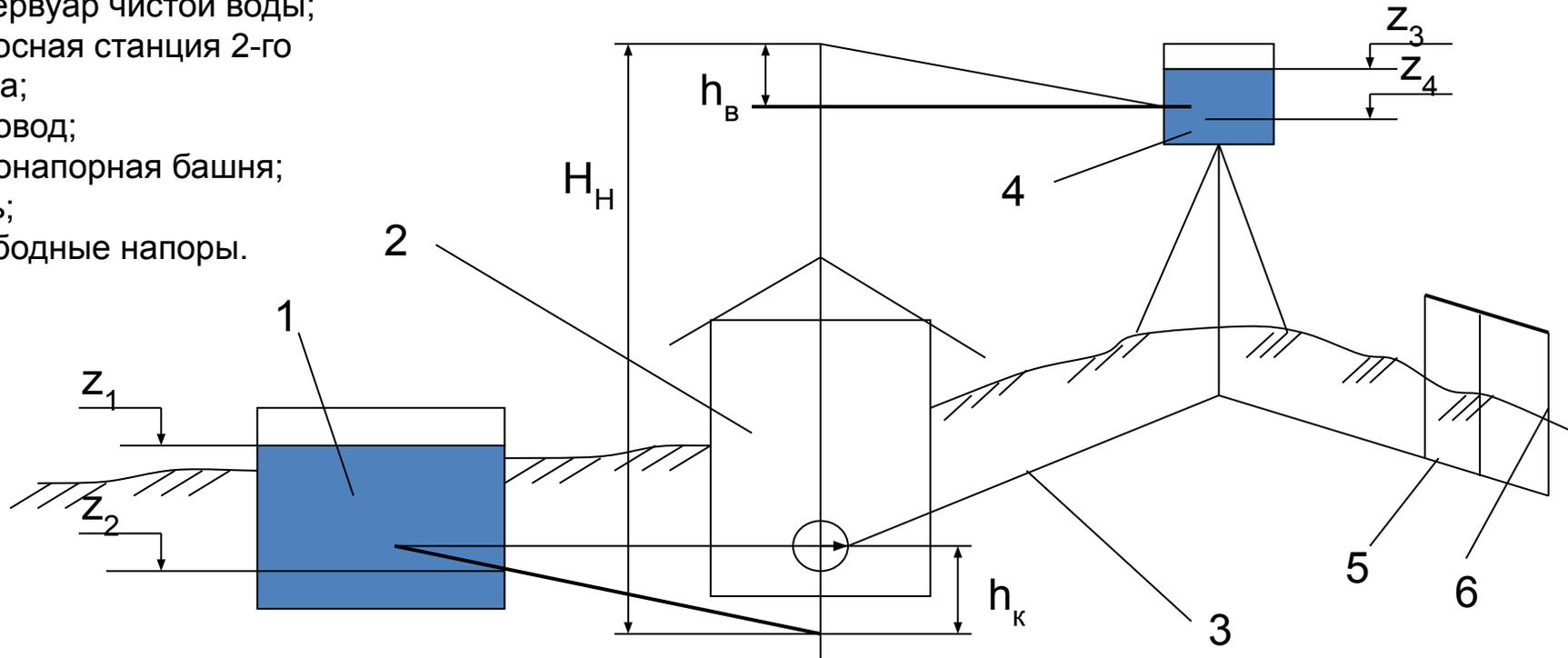
Напор насосов второго подъема определяется по формуле:
