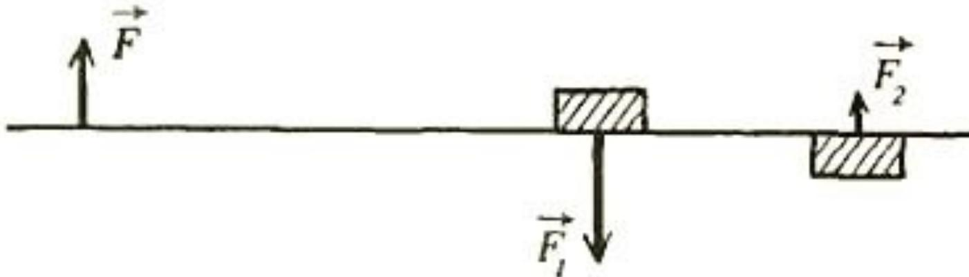
На невесомом рычаге уравновешены стальные шары. Нарушится ли равновесие, если шары погрузить в воду?
