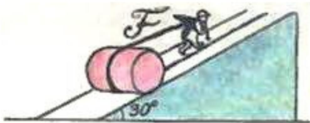
Применение веревки, перекинутой через бочку, дает выигрыш в силе в два раза (подвижный блок), наклонная плоскость (при  $\alpha = 30^\circ$ ) — также в два раза; следовательно, общий выигрыш в силе — в четыре раза.
