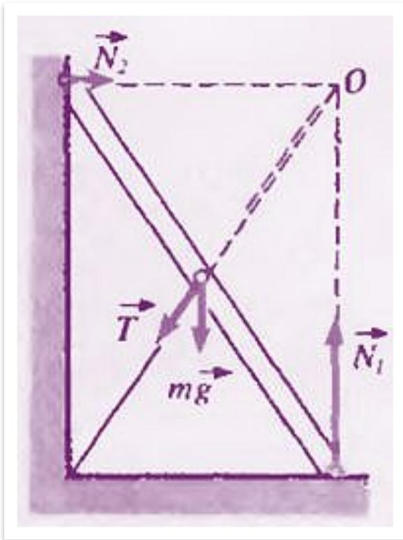
Моменты сил реакции пола и стены, а также момент силы натяжения веревки относительно точки  $O$  равны нулю при любой силе натяжения. Момент силы тяжести относительно той же точки отличен от нуля. Лестница упадет.
