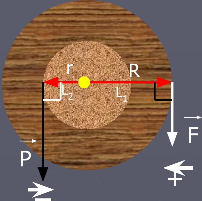
Двойной блок также можно рассматривать как преобразователь силы. И здесь, прикладывая малую силу к верёвке, навитой на блок большего радиуса, мы можем получить большую силу, действующую со стороны верёвки, навитой на блок малого радиуса.
