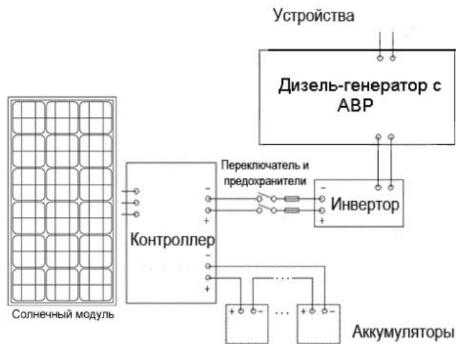
Солнечная батарея (с аккумуляторами) и резервный дизель-(бензо-)генератор.
