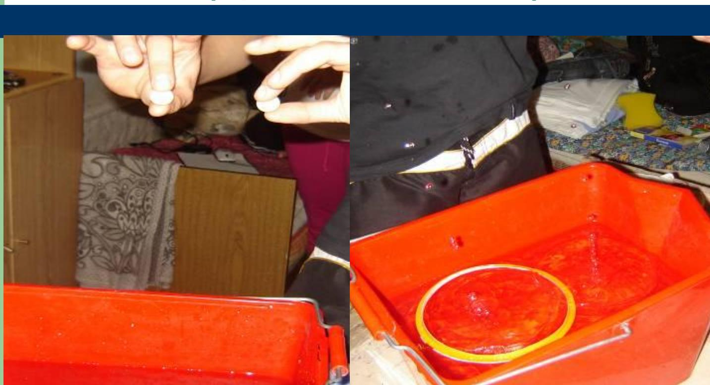
При использовании ПАВ с меньшим коэффициентом поверхностного натяжения, жидкость дает небольшой всплеск.
