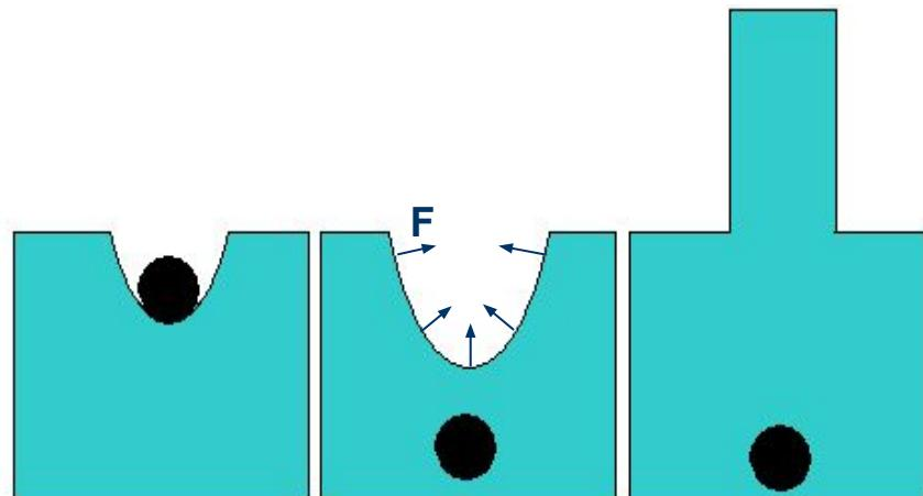
Всплеск возникает потому, что шар, попадая в жидкость, создает в ней углубление (каверну), и оно, в свою очередь, всхлопываясь, создает кумулятивную струю.
