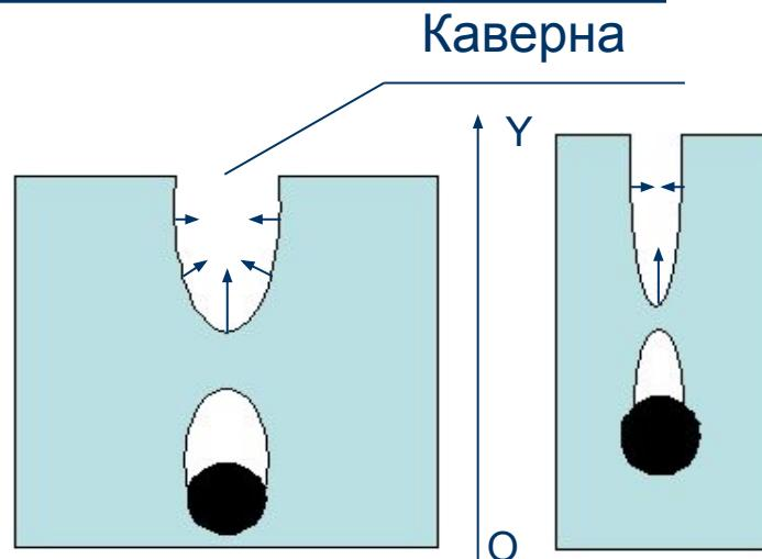
В сосуде малого диаметра каверна сильно вытянута в длину, проекция силы на ось ОY меньше, поэтому всплеск также мал в высоту.
