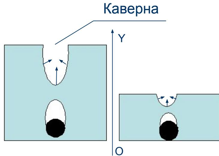
В сосуде с малой глубиной каверна более пологая, поэтому проекция на ось ОY силы, выталкивающей жидкость, меньше, следовательно всплеск меньше в высоту.
